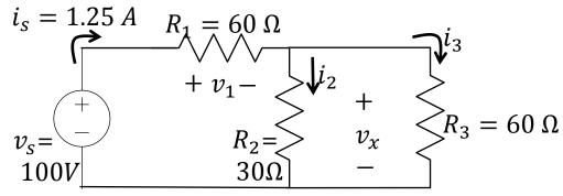
$$i_{2} = i_{s} \frac{R_{3}}{R_{2} + R_{3}} \qquad i$$
